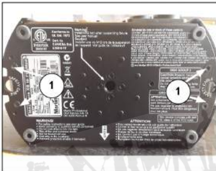
図 40:ベースカバーの取り外し
