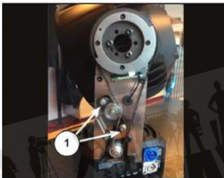
図 32:チルトタイミングベルトの調整
