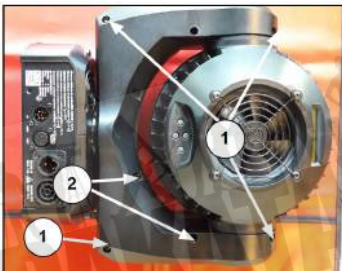
図 29:ヨークカバーの取り外し
